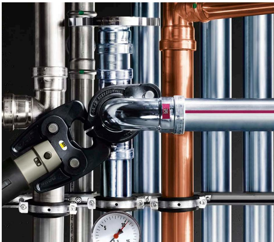
Velike dimenzije cijevi mogu se jednostavno sprešati pomoću press prstena.
