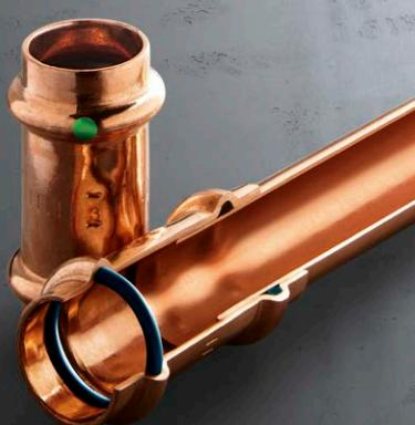
Profipress spojnice za instalacije pitke vode prepoznaju se po točki zelene boje. Sve spojnice izrađuju se od bakra i bronce i imaju EPDM brtveni element.
