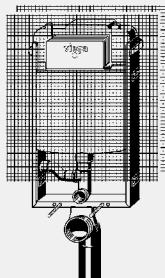
**Prevista Pure-WC blok s priključkom ventilatora za viseći WC**
