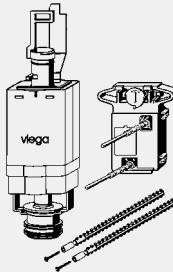
**Garnitura odvodnog ventila**
