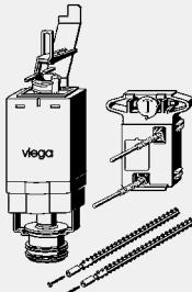
**Garnitura odvodnog ventila**
