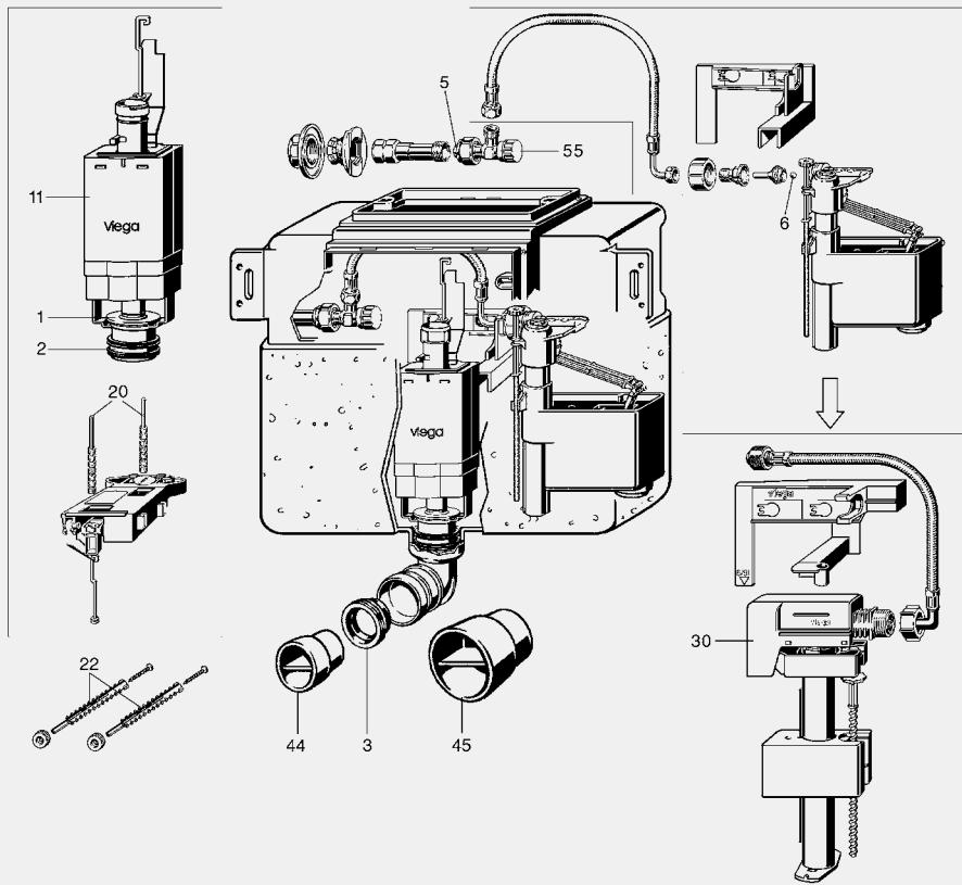
Viega podžbukni vodokotlič 2L za potisne ploče Visign, niskomontažna izvedba, aktiviranje ispiranja s prednje ili s gornje strane, od godine proizvodnje 2014., primjenjeno u:
