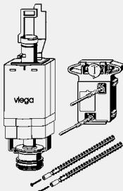
**Garnitura odvodnog ventila**
