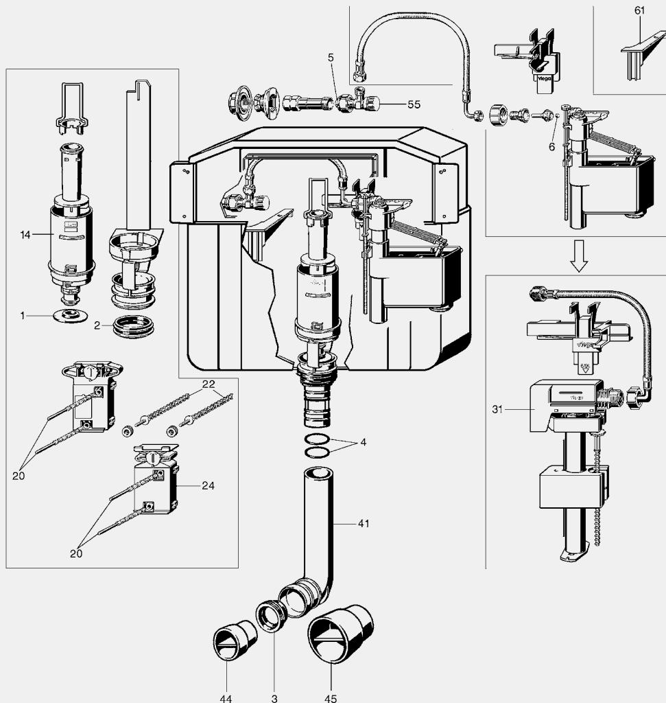
Podžbukni vodokotlič Standard 1S za potisne ploče Standard, sa funkcijom zaustavljanja ispiranja,
