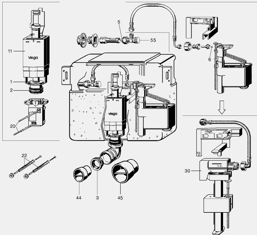
Podžbukni vodokotlič 2L za potisne ploče Visign, niskomontažna izvedba,
