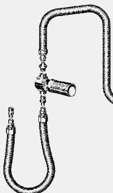
**Set za priključivanje****podžbukni prekidač cijevi**
