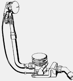
**Rotaplex Trio-Odvod/preljev****Visign RT5****spljoštena izvedba, potrebno samo 33 mm iza kade**
