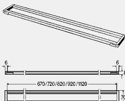
**Advantix-Montažni okvir tuš kanalice
