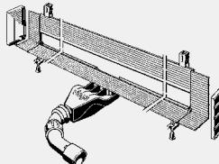
**Advantix Vario-Osnovno kućište tuš kanalice
