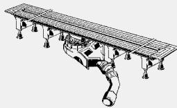
**Advantix Vario-Osnovno kućište tuš kanalice može se kontinuirano skraćivati**
