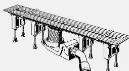
**Advantix Vario-Osnovno kućište tuš kanalice može se kontinuirano skraćivati**
