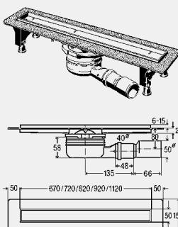
**Advantix-Tuš kanalica****s Advantix rešetkom Visign ER13**
