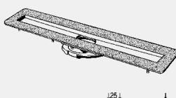
**Advantix-Osnovno kućište tuš kanalice**
