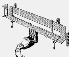
**Advantix Vario-Osnovno kućište tuš kanalice
