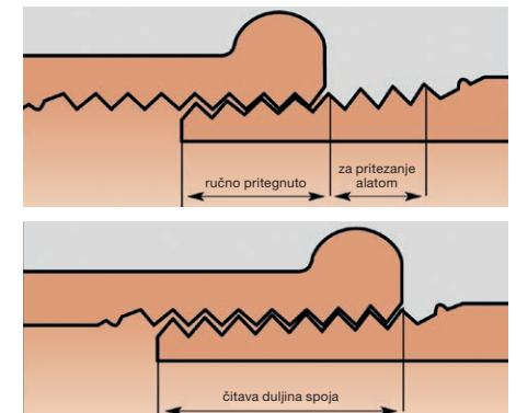
Siguran spoj zahvaljujući koničnom vanjskom i cilindričnom unutarnjem navoju (R/Rp).
