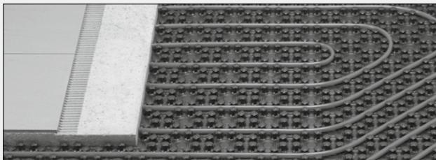
Sustav s ekstremno tankim slojem estriha (35 mm), namijenjen specijalno za renoviranje, u kombinaciji sa čep pločom Fonterra Base ND 11 ili smart te s polibutenskom cijevi 12 x 1,3 mm. Izvodi se samo sa specijalnim aditivom za estrih Fonterra Base Flat. Polaganje se vrši u sljedećim razmacima:
