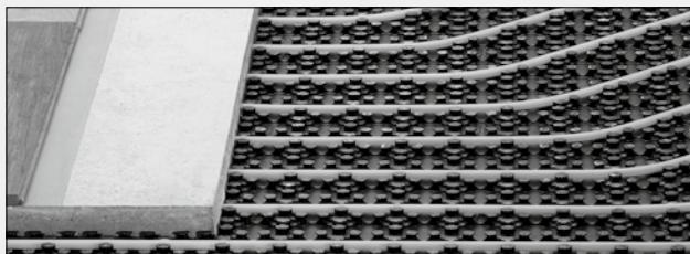
Sustav čep ploča za široko područje primjena sa dvije različite dimenzije PB-cijevi: 12 x 1,3 mm ili 15 x 1,5 mm. Brzo polaganje za koje je dovoljan jedan čovjek pri mnogostrukim mogućnostima izvedbe. Sustav je prikladan za dijagonalno polaganje, kao i za vrlo niske podne konstrukcije (bez izolacije = smart). Polaganje se vrši u sljedećim razmacima:
