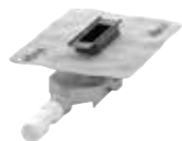
Model: 4981.81 Sanacija odvodnog kućišta Visina montaže: od 70 mm Visina zaporne vode: 25 mm Učink odvoda: 0,4–0,55 l/s*
